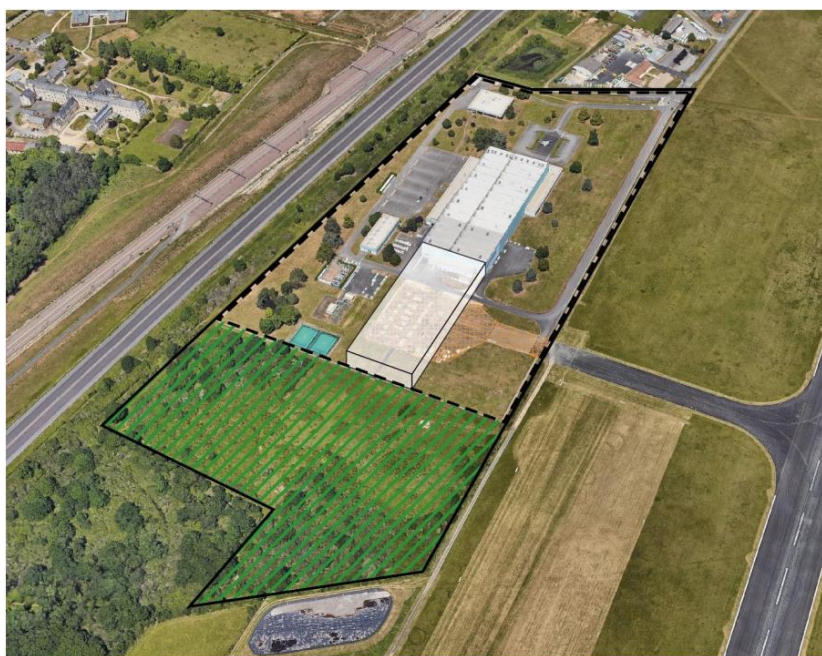
Le projet d'extension bâtiminaire sur le site de Dassault Aviation – Source SCE, d'après les plans projetés Extension du bâtiment en lieu et place des modulaires installés de manière transitoire sur le taxiway plus utilisé. Implantation de l'ensemble des infrastructures nécessaires à l'activité au sein de périmètre clôturé. Maintien de la partie naturelle en bout de parcelle.
