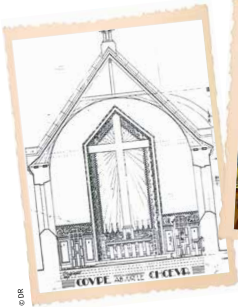
▲ Du projet à la réalité, la structure totalise 41 panneaux maintenus au mur par des tirants de fer.
